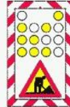
Semnalizarea unui utilaj care se deplasează lucrând
