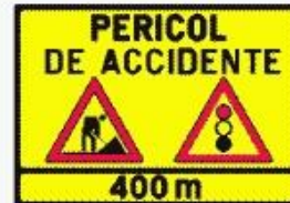
Presemnalizarea unui sector cu circulație alternantă
