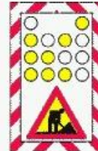
Semnalizarea unui utilaj care se deplasează lucrând
