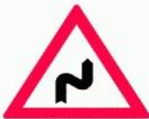
Curbă dublă sau o succesiune de mai mult de două curbe, prima la dreapta
