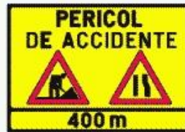
Presemnalizarea unui sector cu circulație alternantă
