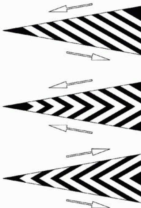
Spații interzise circulației
